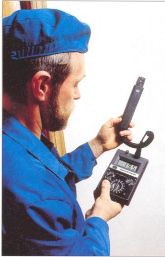
Рис.2.13. Контроль вологості основи й температури, відносної вологості повітря в приміщенні
