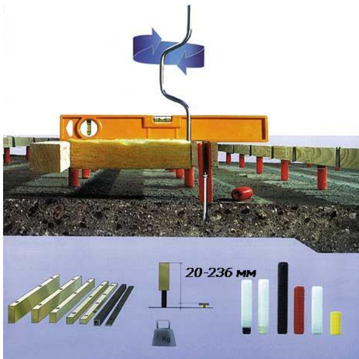
Рис. 1.18. Схема влаштування основ по регульованих лагах.
