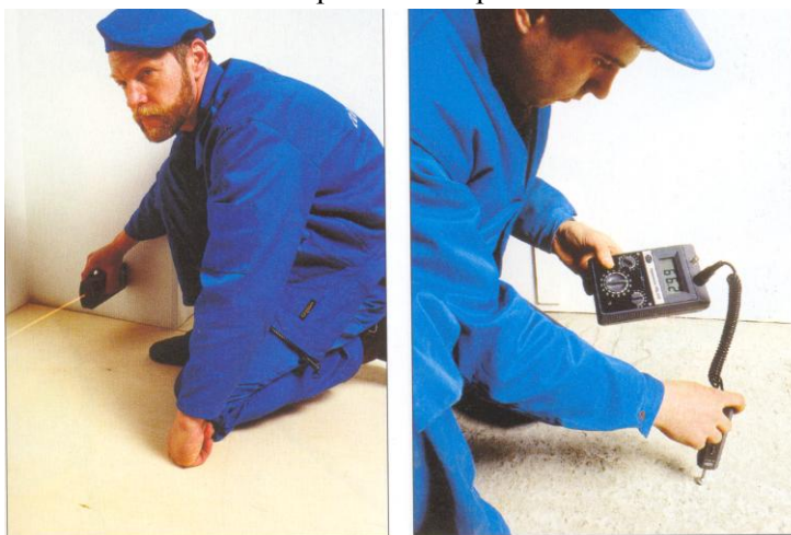
Рис. 2.7. Точне визначення розмірів приміщення електронним лазерним вимірником
