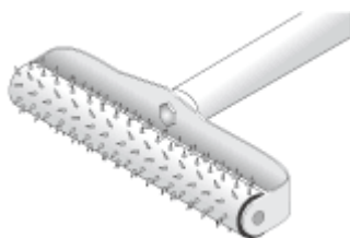
Рис. 1.23. Игольчатый валик для прокатки ГКЛ
