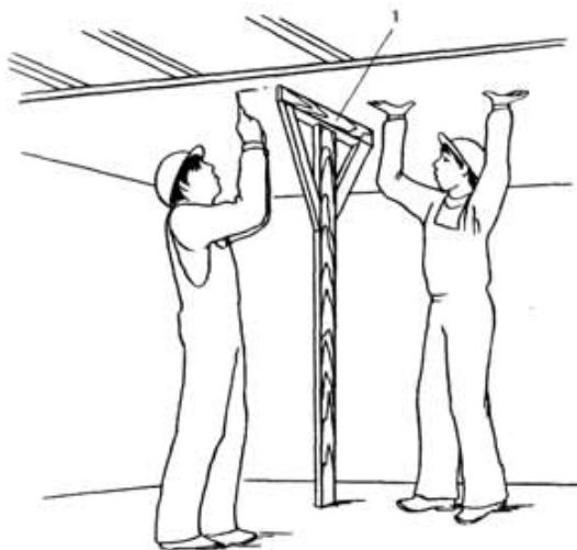
Рис. 2.24. Монтаж гипсокартонных листов на потолке 1 – Т-образная подставка
