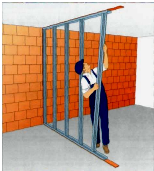
Рис. 2.18. Крепление стоечных профилей к направляющим
