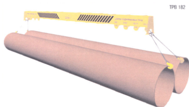
Рис. 2.2. Схема строповки труб: а) клещевой захват, б) торцевой захват, в) траверсы и г) мягкие полотенца
