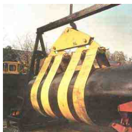
Рис. 2.2. Схема строповки труб: а) клещевой захват, б) торцевой захват, в) траверсы и г) мягкие полотенца
