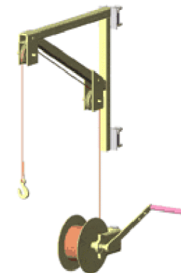
Рис. В.8. Лебедка ручная Грузоподъемность - 30 кг
