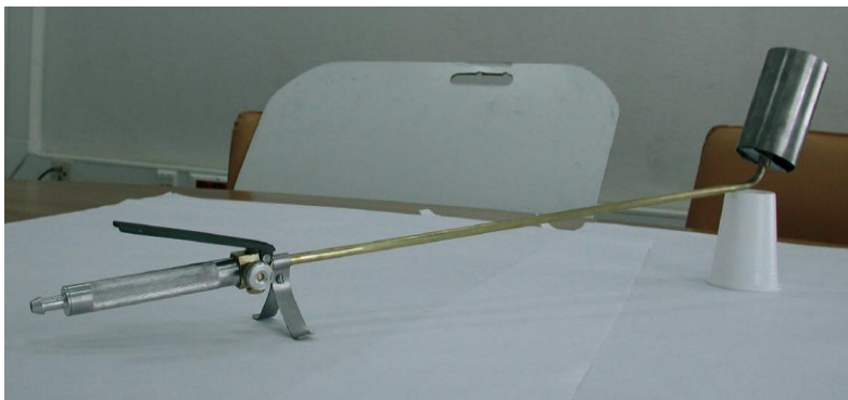
Рис.4.33 Горелка газовоздушная инжекторная ГГ-2С/2Сэко
