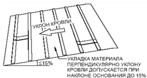
Рис.4.7 Укладка материала на скате кровли
