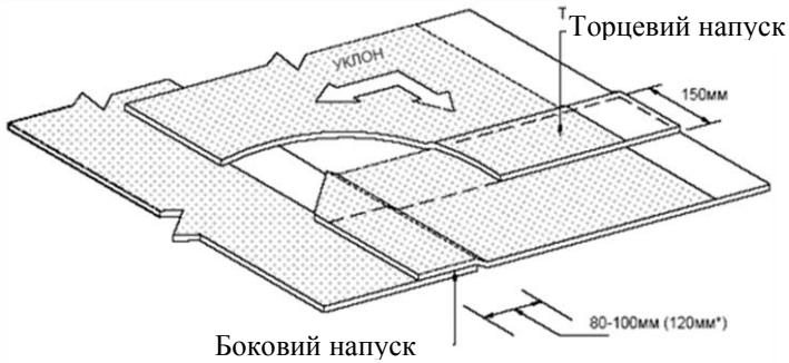
Рис.4.8 Напуски полотнищ рулонного матеріалу
