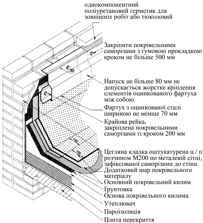
Рис.4.14 Примикання покрівельного килима до вертикальної поверхні
