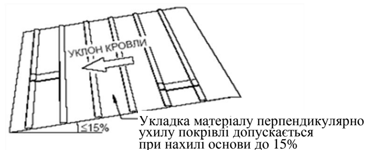
Рис.4.7 Укладання рулонних матеріалів на скаті лах
