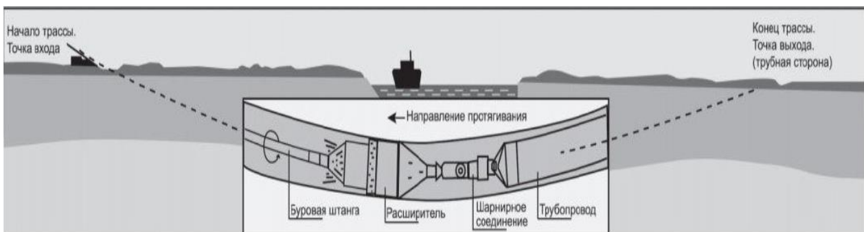
Рис. 4.3. Протягування трубопроводу через буровий канал на бурову установку
