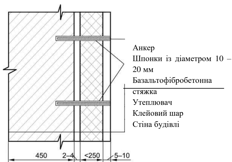
Рисунок 2.13 - Конструктивна схема утеплення зовнішніх стін житлових панельних будинків жорсткими пінополістиролбетонними плитами з базальтофібробетонним облицюванням
