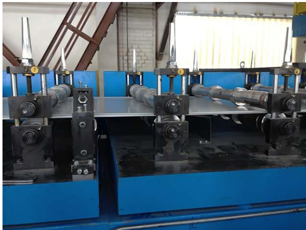
Рисунок 5.8 – Фото-фрагмент 2-го етапу (нанесення захисної плівки)
