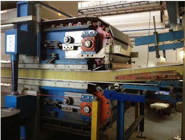
Рисунок 5.11 – Фото-фрагмент 5-го етапу (сендвіч-панель подається в прес)
