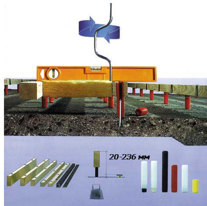
Рис. 1.18. Схема устройства основания по регулируемым лагам.
