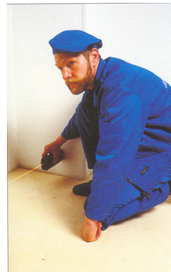
Рис. 2.7. Точное определение размеров помещения электронным лазерным измерителем
