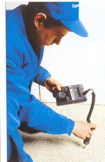
Рис. 2.8. Измерение влажности основания влагомером
