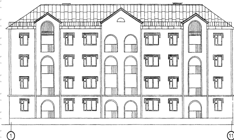
Рис. 3.1. Фасад чотирьохповерхового будинку
