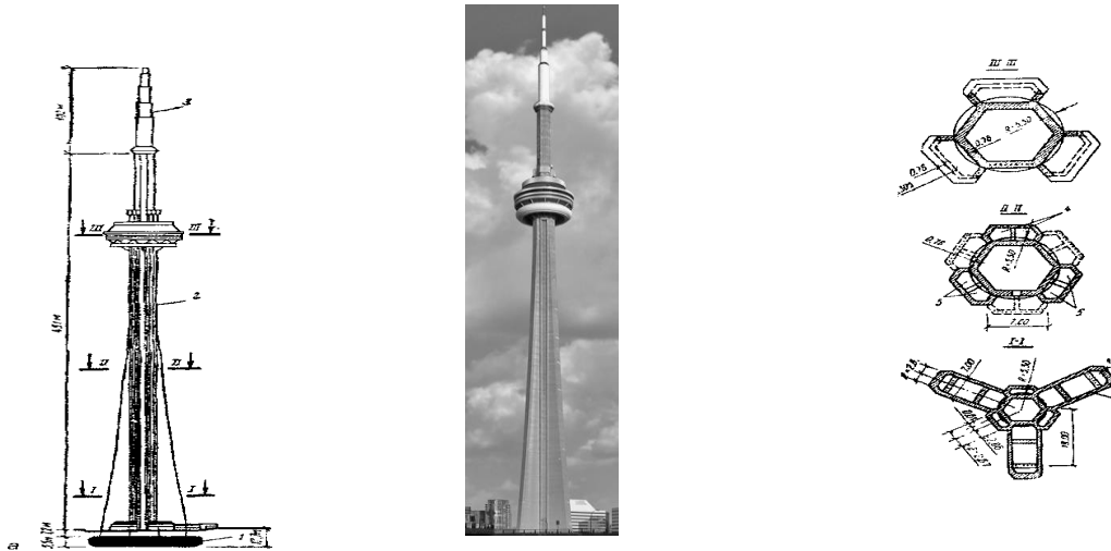
Рис. 4.26. - Схема конструкцій телевежі «Сі-Ен Тауер» (Торонто):
