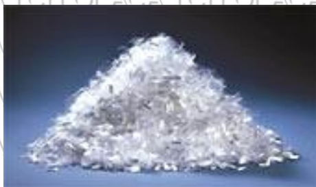
Рис. 1.23. Поліпропіленове волокно для армування
