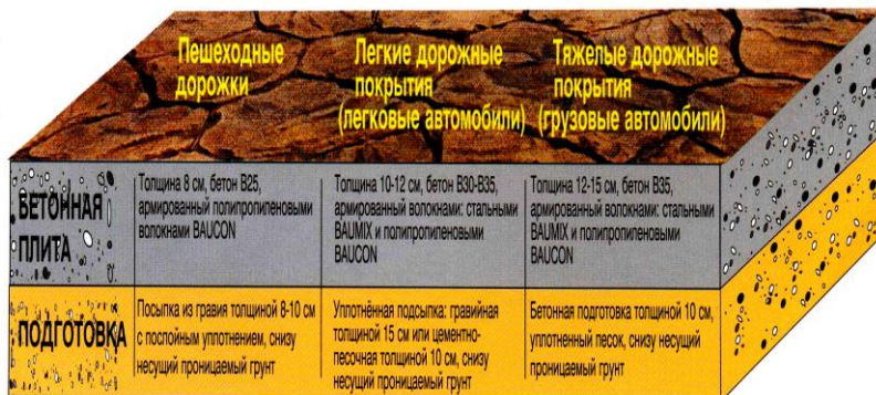
Рис. 1.24. Структура підлог по технології PRESSBETON
