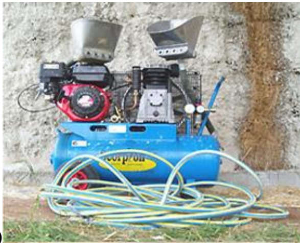
Рис.2.3. Хопер-розпилювач із компресорною станцією а) загальний вид; б) нанесення на поверхню
