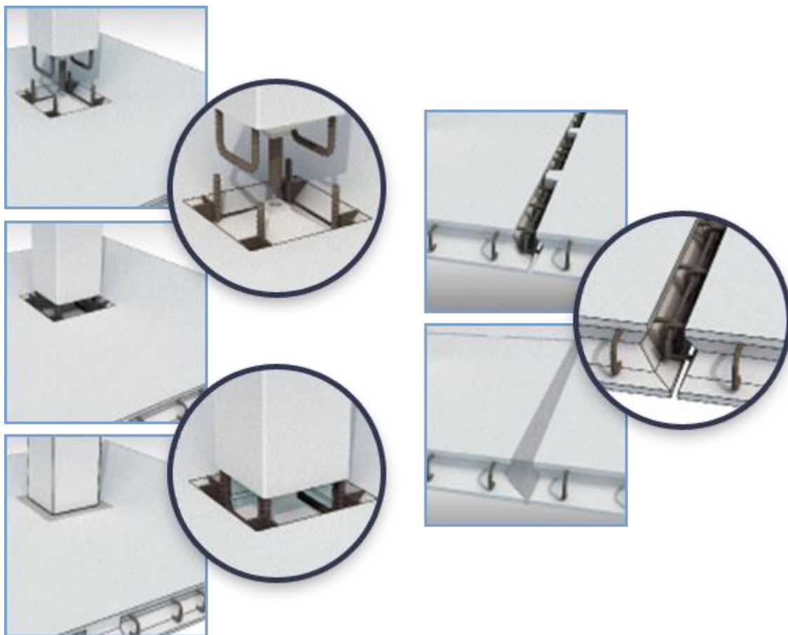
Рис. 2.15 Вузли спряження елементів системи «КУБ-2.5»
