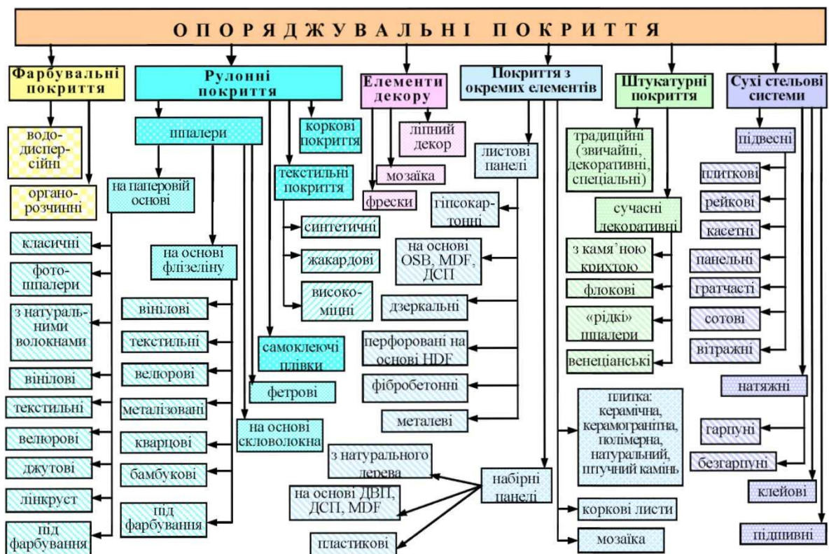
Рис. 5.1– Класифікація опоряджувальних покриттів
