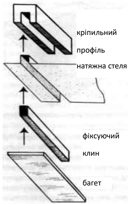
Рис. 8.9. Безгарпунна установка кріплення
