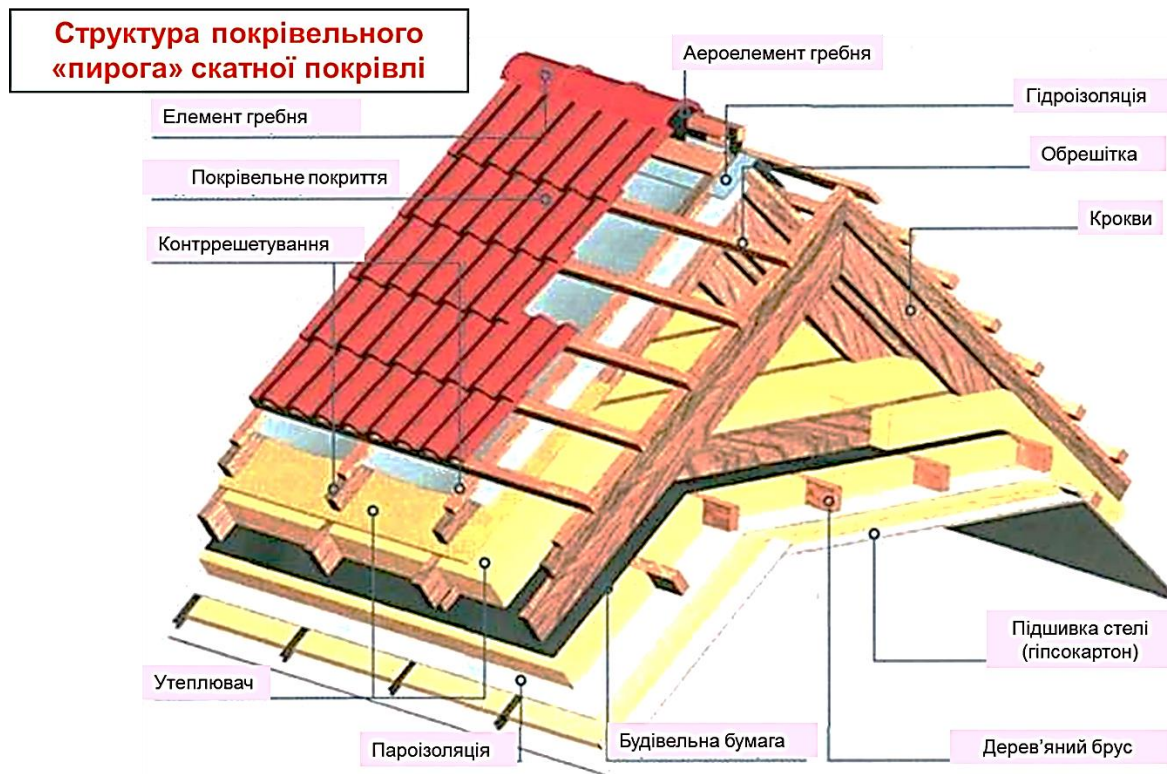
Рис.2.4 – Структура покрівельного «пирога»
