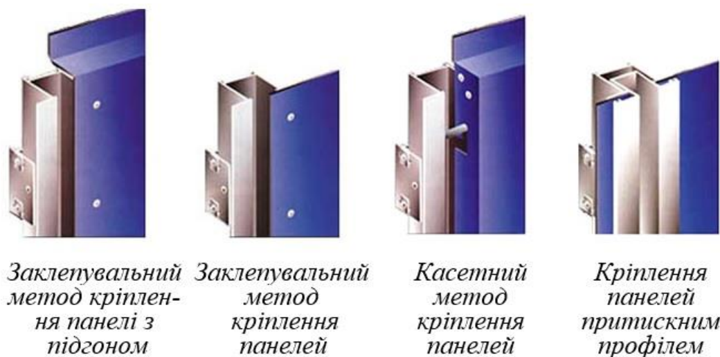
Рис. 4.7 – Способи кріплення металевих облицювань
