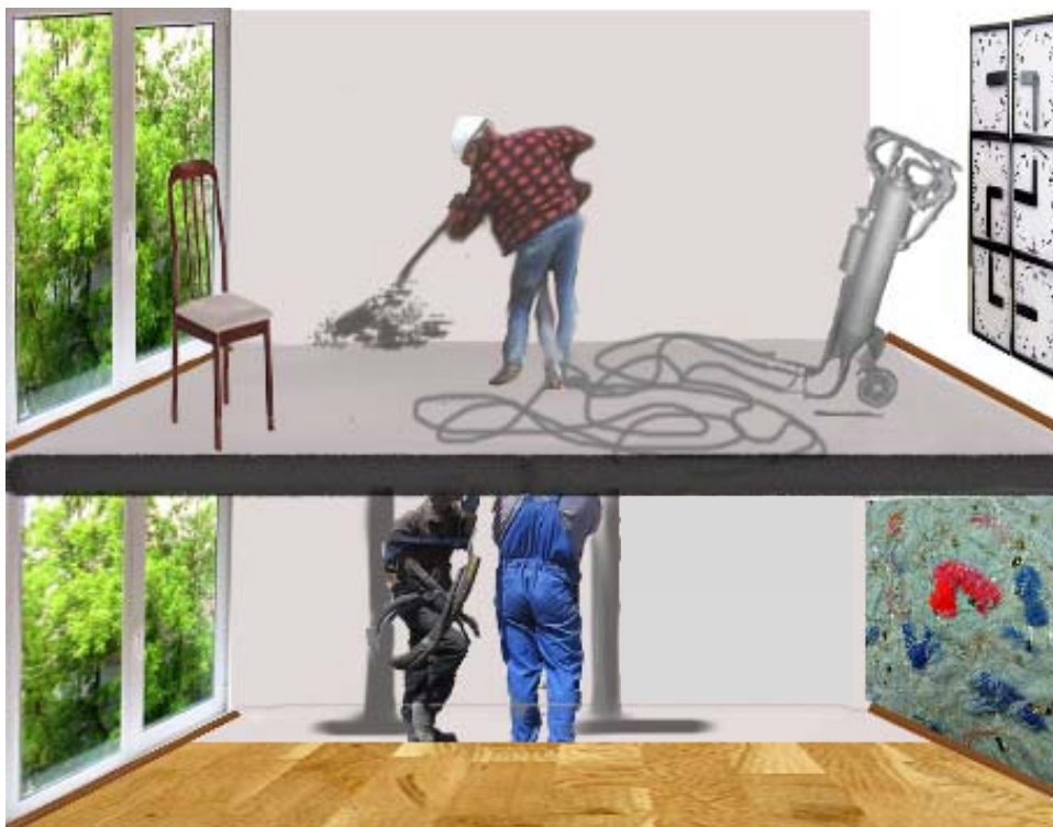
Рис. 27. Технологічний процес відновлення покриття за допомогою телескопічних стійок.
