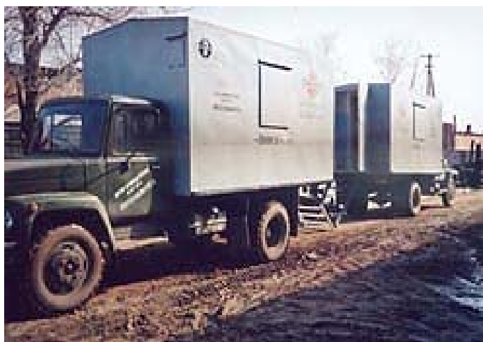
Рис. 14. Пульти управління та насосна станція в спеціальних контейнерах на базі автомобіля ГАЗ-3307.
