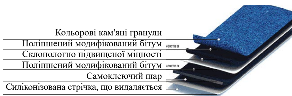
Рисунок 3.6 – Структура бітумної черепиці КАТЕРАЛ
