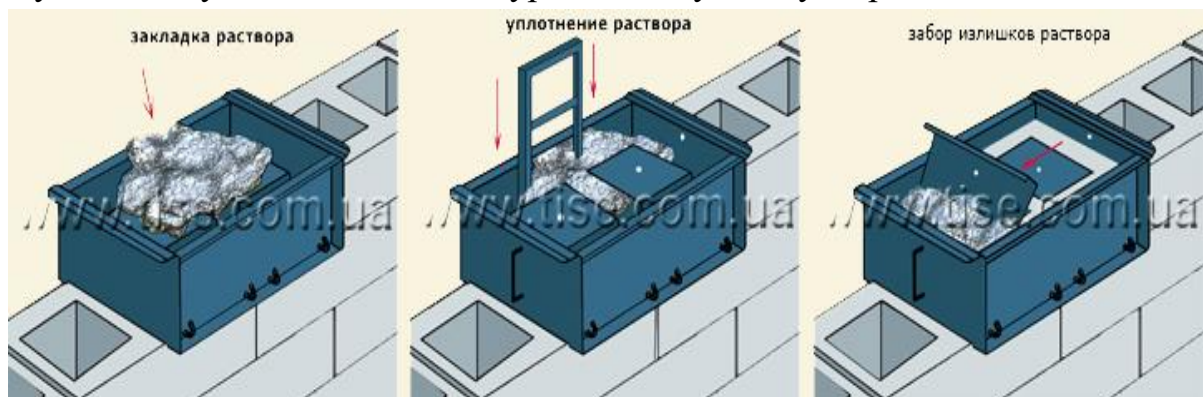
Рис.2.5. Формування блоків «ТИСЭ»
