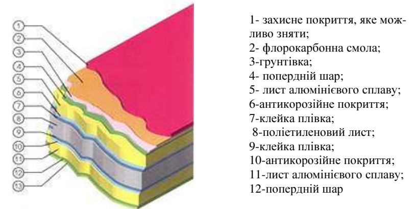
Рис. 3.30. Структура композитної панелі Алюкобонд
