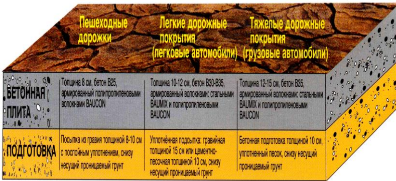
Рис. 1.24. Структура підлог по технології PRESSBETON
