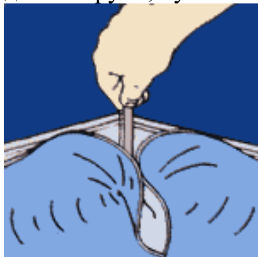
Рис.2.13. Укладання лінолеуму у внутрішніх кутах
