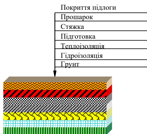
Рис. В.1. Підлога на ґрунті
