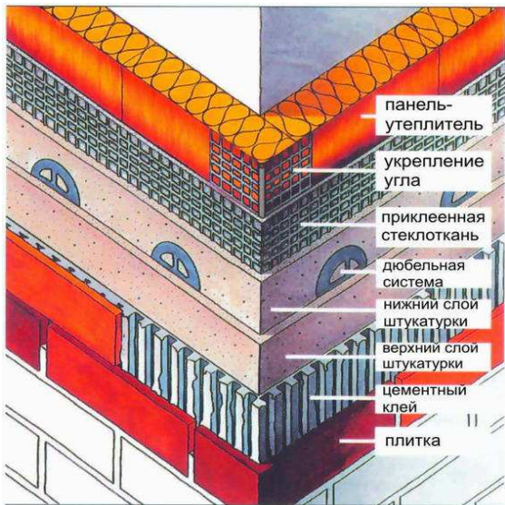
Рис. 3.6 – Структура фасадної системи
