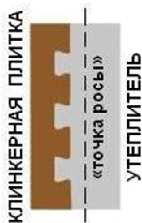
Рис. 3.8 – З'єднання облицювання з утеплювачем
