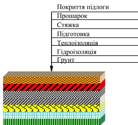
Рис. В.1. Підлога на ґрунті
