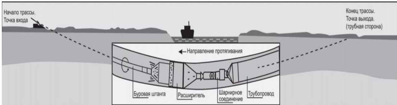
Рис. 3.5. Протягування трубопроводу через буровий канал на бурову установку
